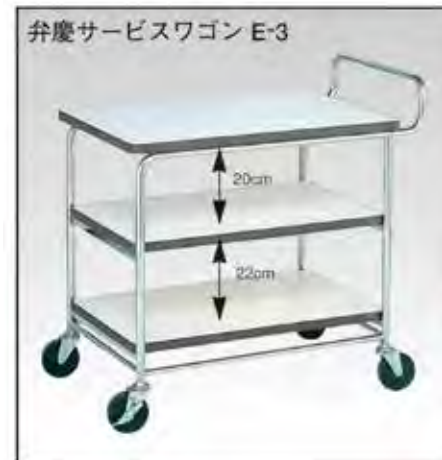
弁慶サービスワゴン E-3 ¥104,000 ■フルサイズ：(L)830×(W)500×(H)810mm ■キャスター：自在φ100mm×3 ストッパー付×1 ■耐荷重：50kg ■材質：ステンレスパイプ、タナ板デコラ合板
